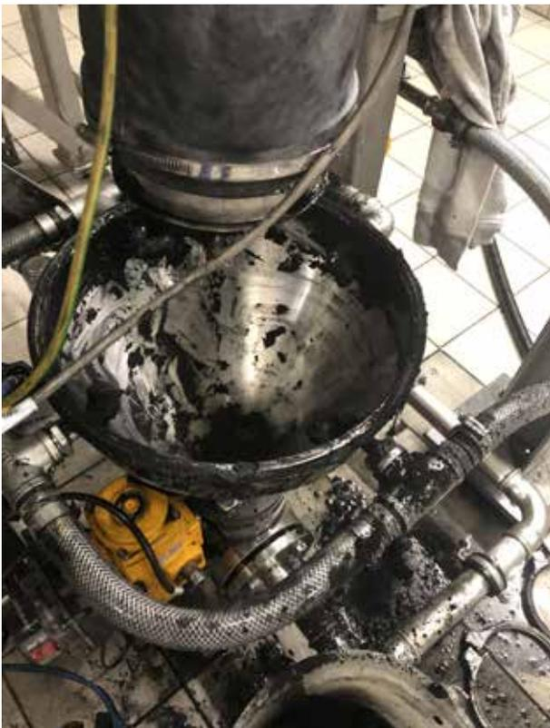
Reinigung des Einspültrichters aufgrund nicht optimaler Vermischung von Kohle und Wasser
